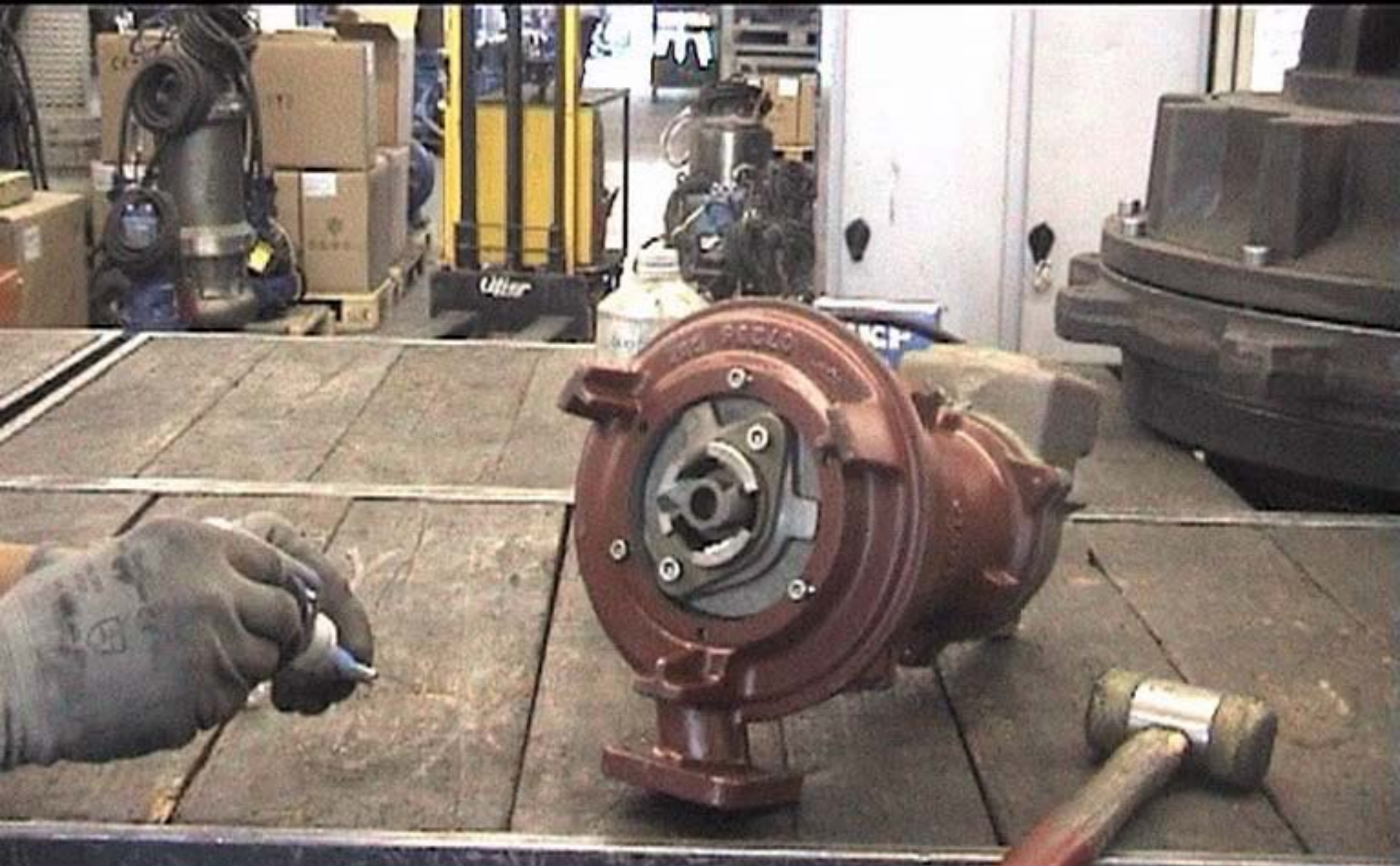
Frena filetti medio sulla vite di serraggio girante Glue on the impeller locking screw
