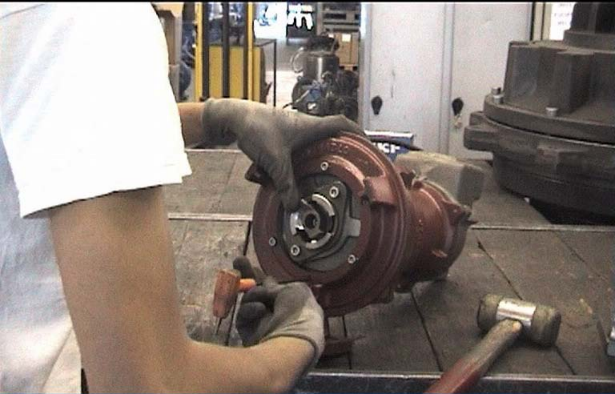
Serraggio viti di registro Locking of the internal adjusting screw
