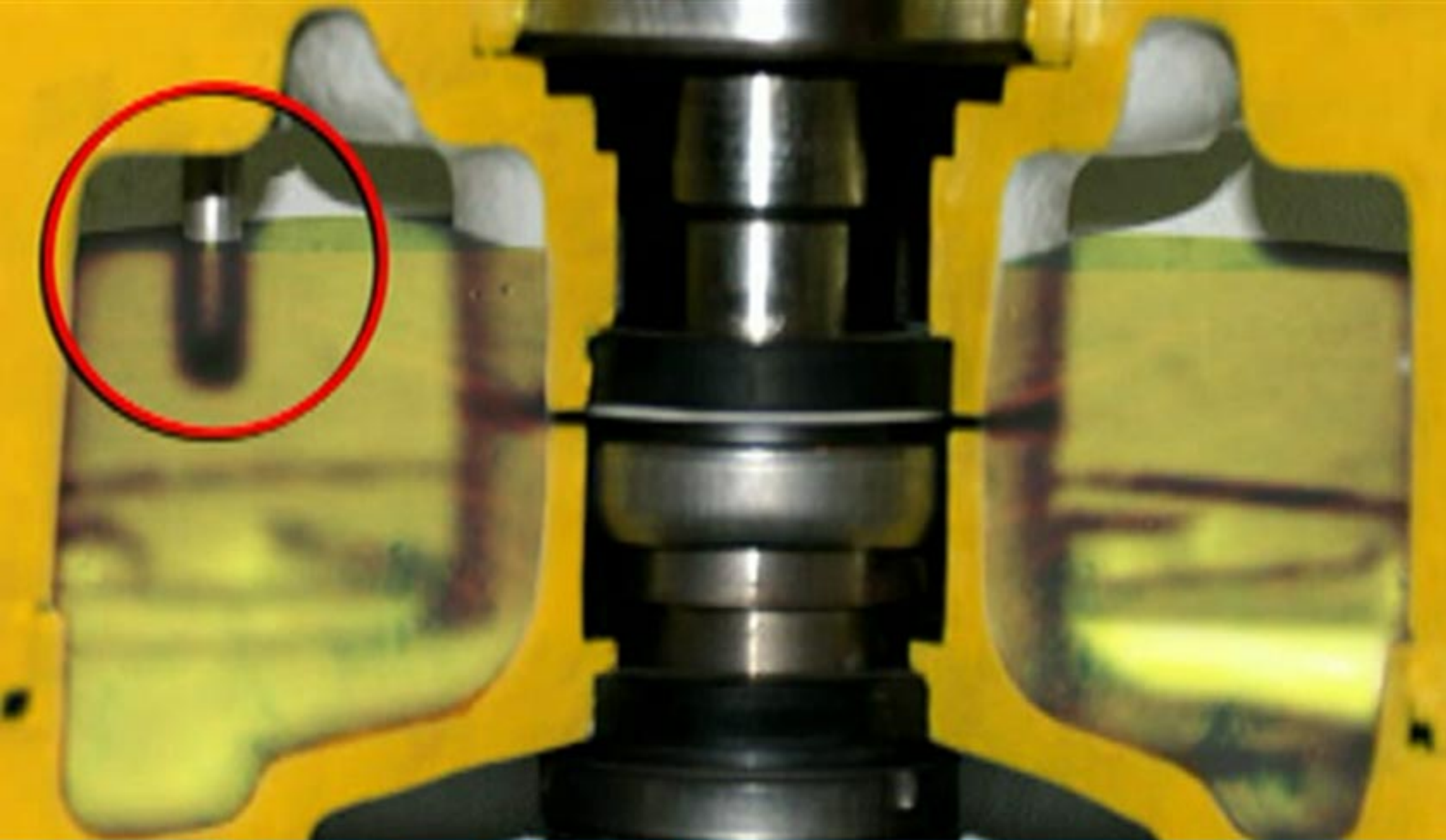
Particolare della sonda presente nella camera olio. Detail of the moisture probe on the oil chamber side.
